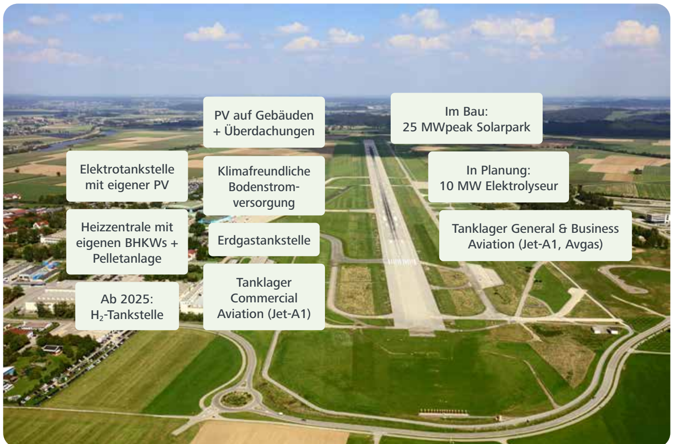
Komponenten der Energieversorgung am Flughafen Memmingen
